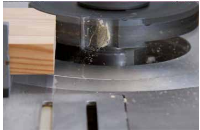
Chip flow system - optimized chip discharge. Sistema di scarico del truciolo - evacuazione del truciolo ottimizzata.
