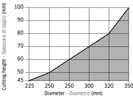
Maximum depth of cut based on the blade diameter. Altezza di taglio massima consentita in funzione del diametro della lama.
